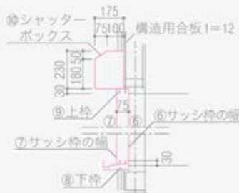
図 1 階サッシ外枠の下書き (図 F 参照)
