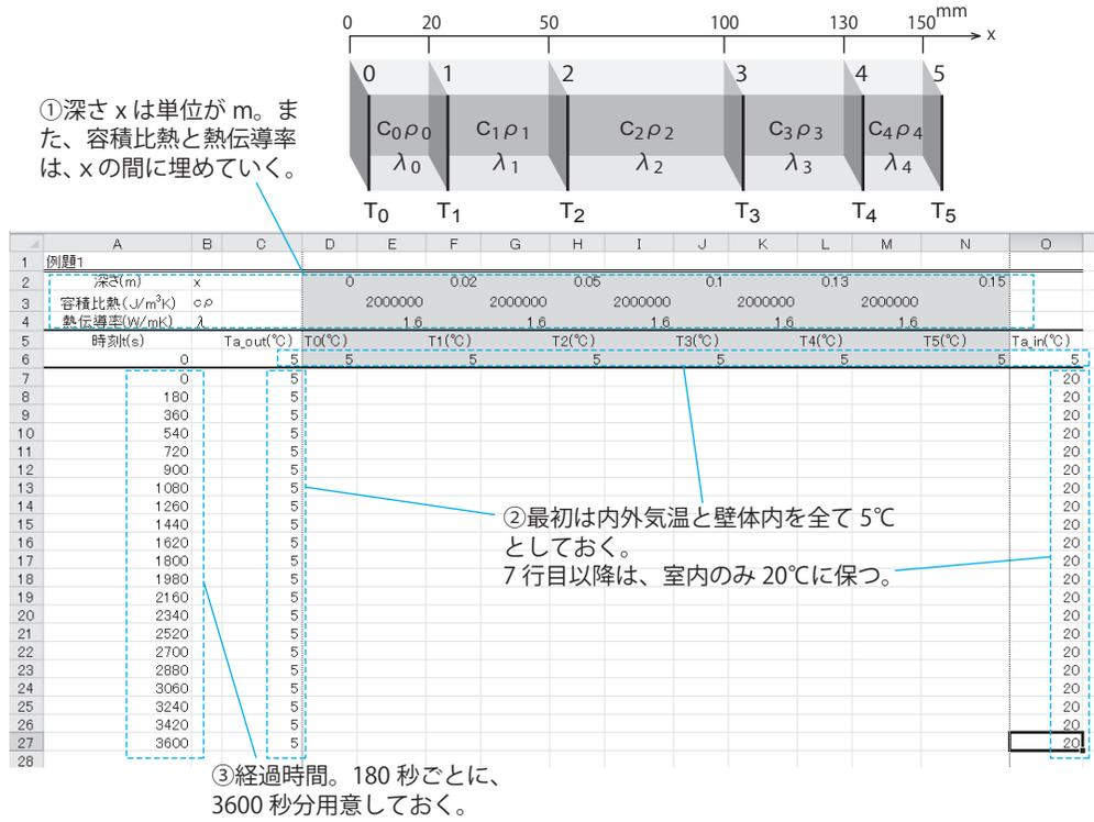
図1 壁体内伝熱の時刻変化を求める準備
